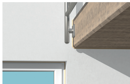
Juntas de conexão na fachada externa
