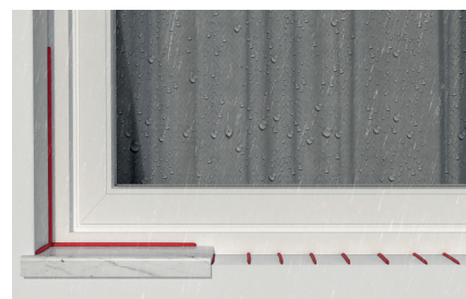
Selagem e colagem de peitoril de janelas
