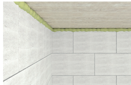
Encunhamento de alvenaria
