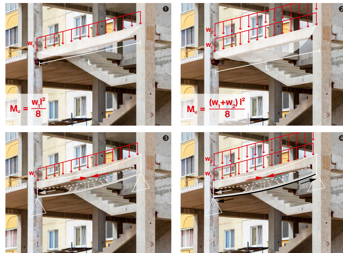
Esquerda: viga sem reforço | Direita: viga reforçada à flexão
