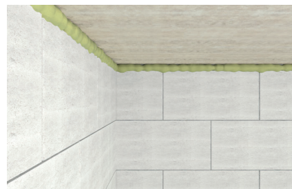
Encunhamento de alvenaria
