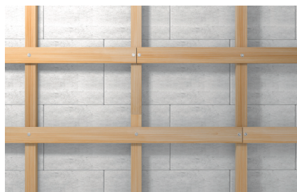
Subestruturas de madeira
