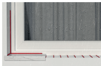
Selagem e colagem de peitoril de janelas
