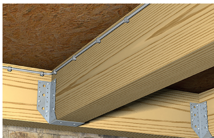
Fixação de cabos elétricos
