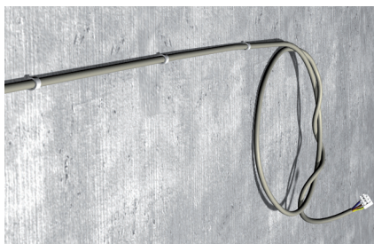
Fixação de fios paralelos
