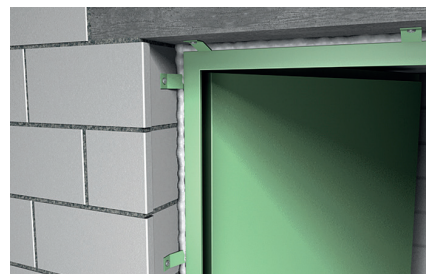
Fixação de batentes de portas e janelas
